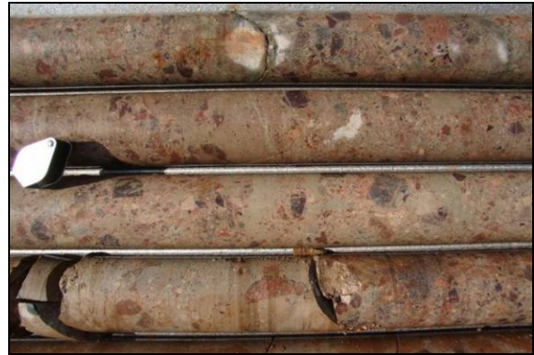
H) Polymictic matrix supported rubble/fluidised breccia (S1-001)
